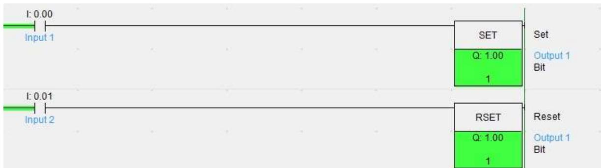
Untuk mematikannya, kita menggunakan Reset. **Reset** adalah kebalikan dari Set, berfungsi untuk merubah kondisi koil/output dari Off atau On menjadi kondisi **OFF** (0).
