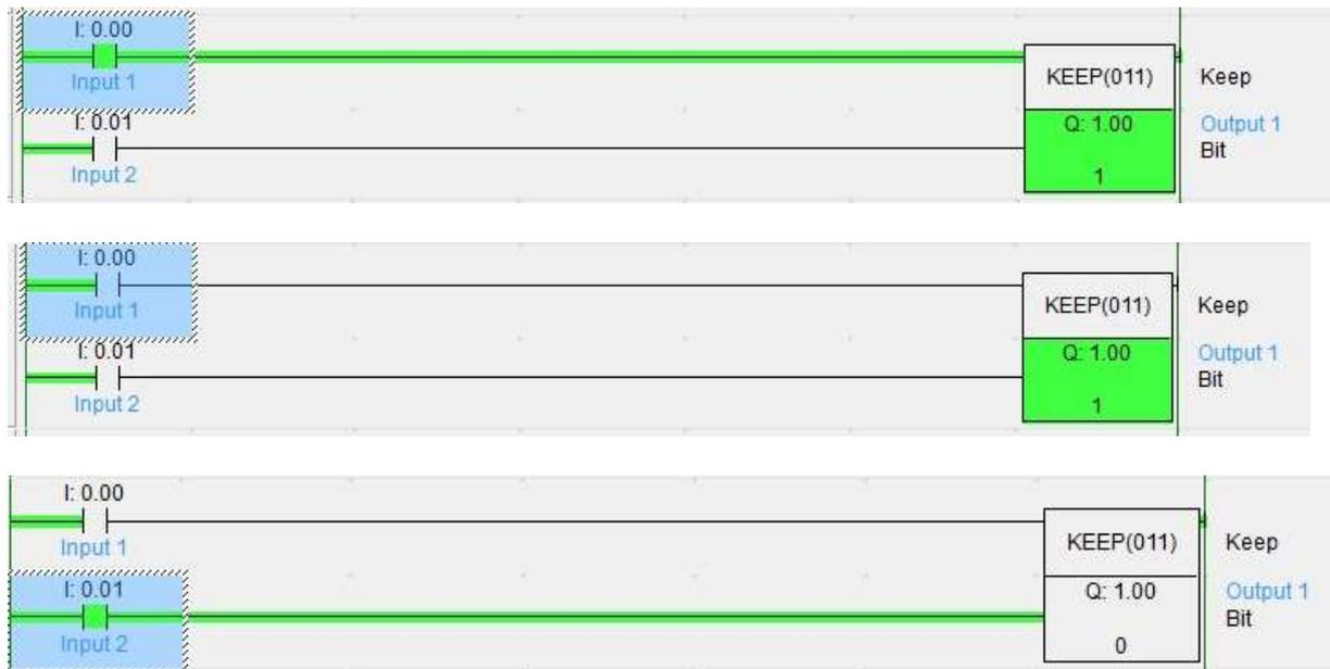
Kesalahan umum yang sering dilakukan pemula saat menggunakan instruksi Set/Reset atau KEEP adalah memutus instruksi Set untuk mematikan koil, yaitu memberi kontak NC di sebelah kanan kontak 0.00. hal ini sudah pasti sia-sia, karena tanpa kontak NC pun arus sudah terputus dengan dilepaskannya tombol pada kontak 0.00.
