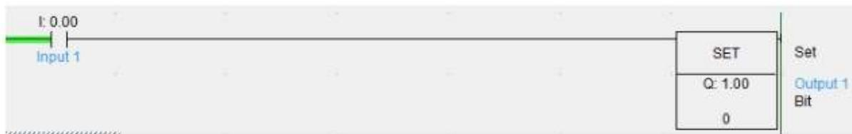
Set adalah perintah untuk merubah kondisi koil/output dari Off atau On menjadi kondisi ON (1), kemudian kondisi ini dipertahankan selama PLC masih dalam status Run.
