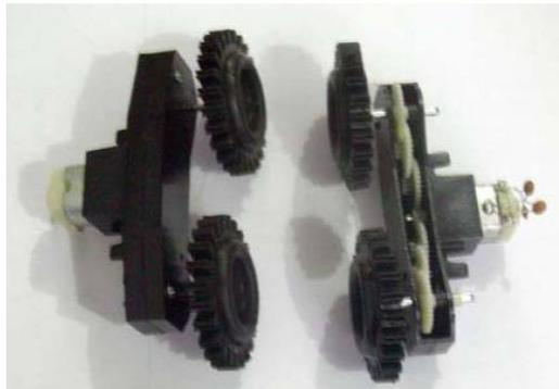
Gambar 8.5. Motor DC dengan Gear
