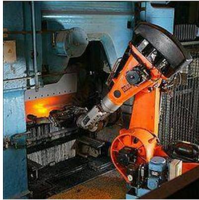
Gambar 2.1. Contoh Aplikasi Robot dalam Proses *pick and place*
