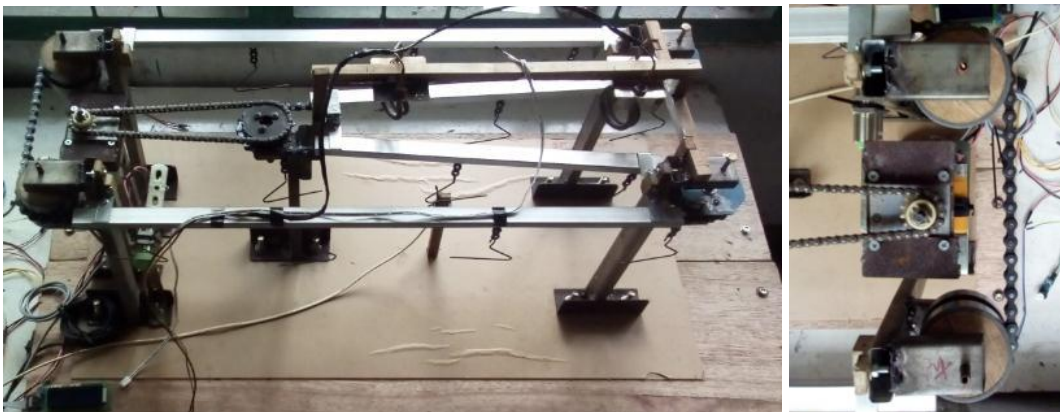
Gambar 5.2 Konstruksi Komponen dan Rel Penggerak Rantai
