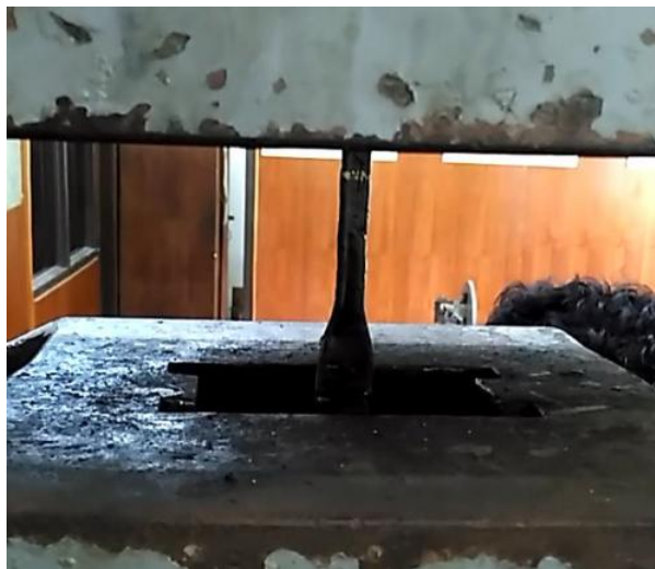
Gambar 10. Proses Uji Tarik Benda Uji Material Komposit Karet
