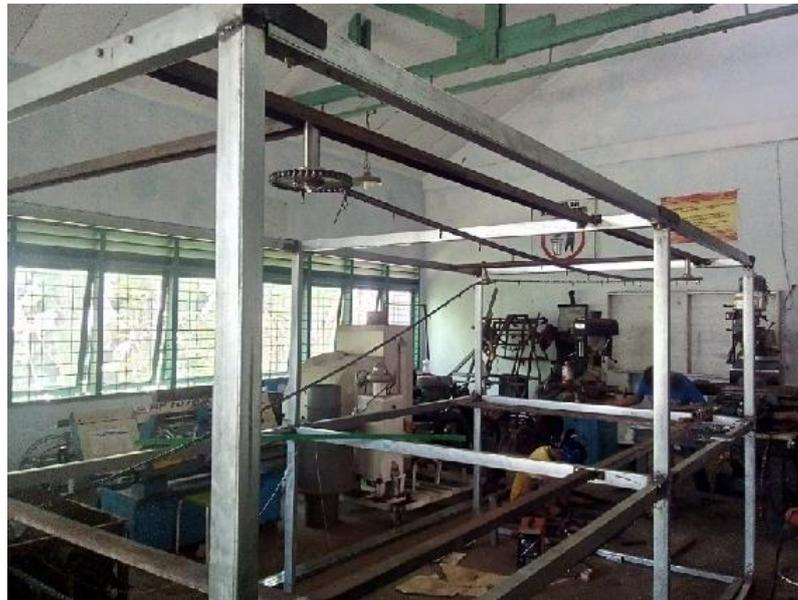
**Gambar 6.2 Rangka Mesin Pengering Karet Skala 1:1**
