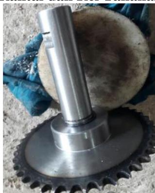
**b. As Sprocket dan Sprocket**
